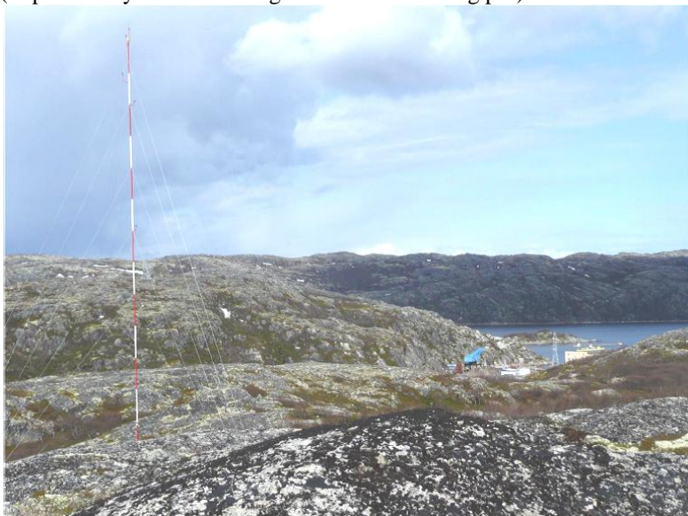
Рис. 4.5. Ветроизмерительный комплекс для мониторинга скоростных характеристик ветра. Мурманская область, район Кислогубской приливной станции. (Источник: официальный сайт ООО «Активити». Электронный ресурс. http://activity-llc.com/goals/windmonitoring . Дата обращения: 06.07.2021)
