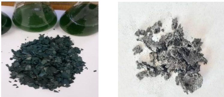
Рис. 8.8. Биомасса микроводорослей (слева) и биоуголь (справа) после пиролиза.
