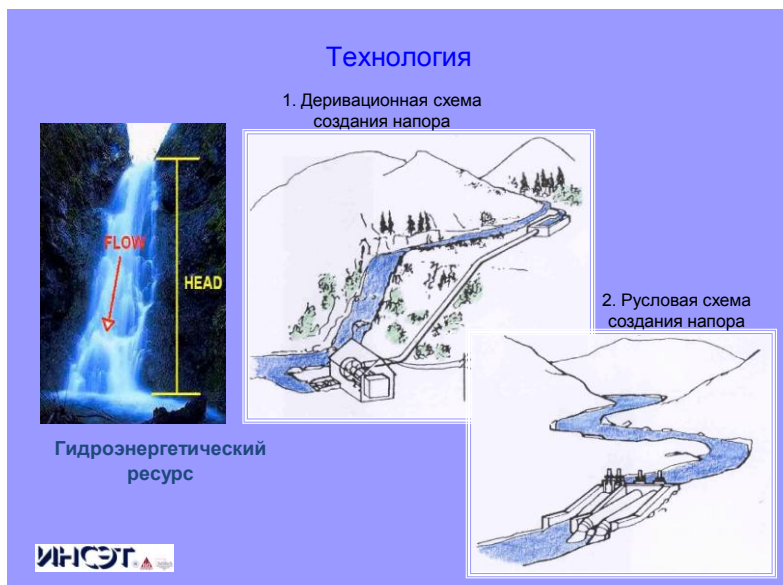
Рис. 2.11. Иллюстрации к схемам организации водного потока для МГЭС. (Источник: доклад Бляшко Я.И. (к.т.н., директор АОЗТ «МНТО ИНСЭТ» «Перспективы использования малой гидроэнергетики в условиях Севера и вечной мерзлоты». Москва, МГУ имени М.В.Ломоносова, Школа ВИЭ, 2020 г.)
