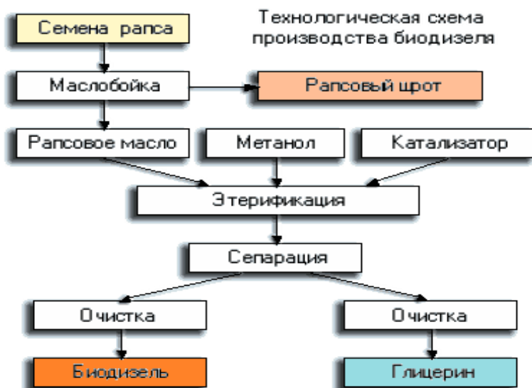
Рис. 3.2. Последовательность технологических операций при получении биодизеля
