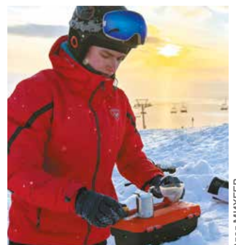
Измерение плотности снега плотномером на северном склоне горы Айкуайвенчорр
