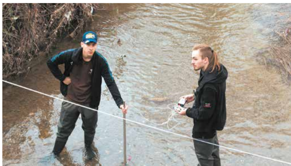
Измерение расхода воды в р. Каче
