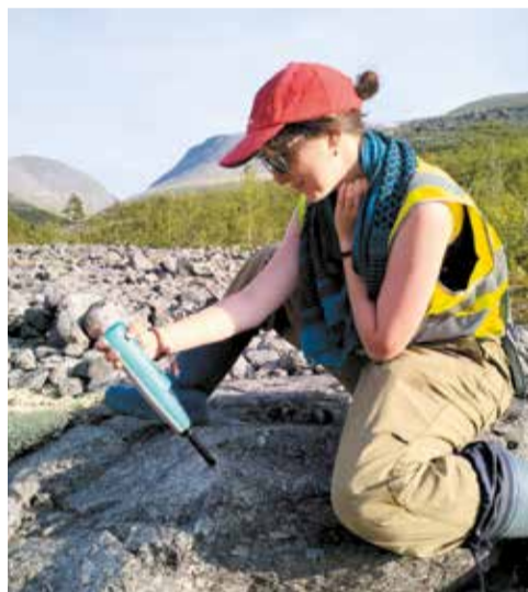
Измерение степени выветрелости породы молотком Шмидта
