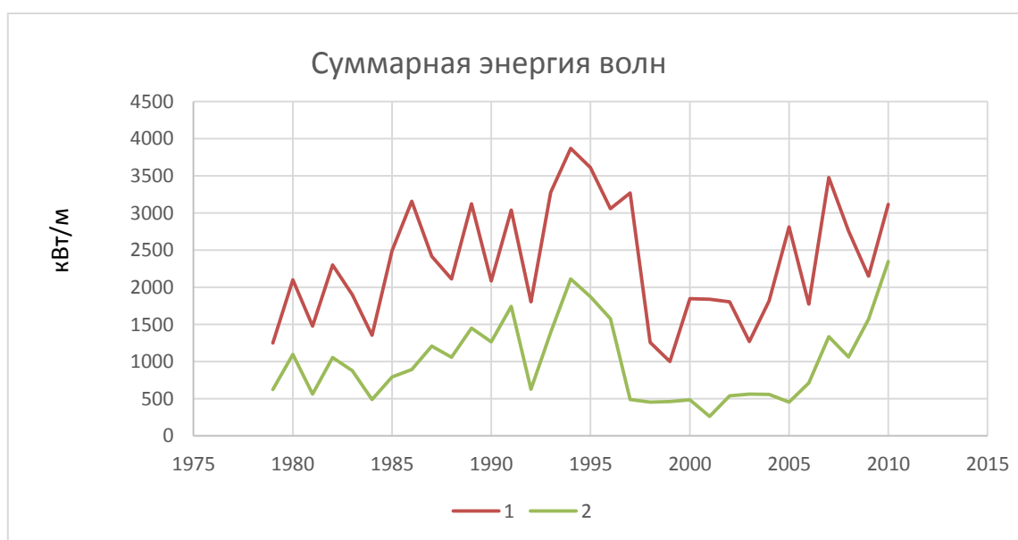
Рис. 2. Суммарная энергия волн по годам: 1 - ячейка модели, ближайшая к ГМС Марресале и пос. Харасавэй; 2 - ячейка модели, ближайшая к Уральскому и Ямальскому берегам Байдарацкой губы.
