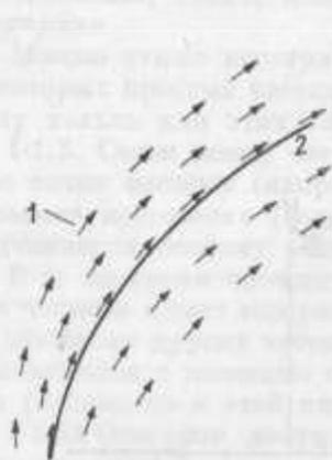
Рис. 1-2. Линии тока, полученные фотографированием с короткой выдержкой частиц, рассеянных в жидкости. 1 — вектор скорости; 2 — линия тока.
