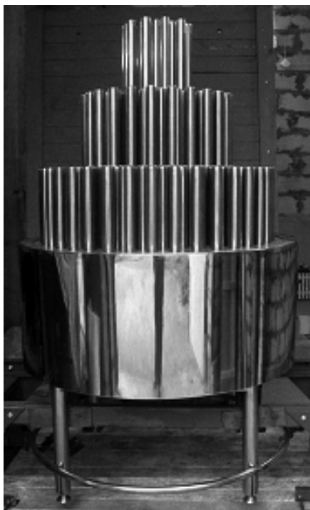
Рис. 7. Модель капиллярного конденсора
