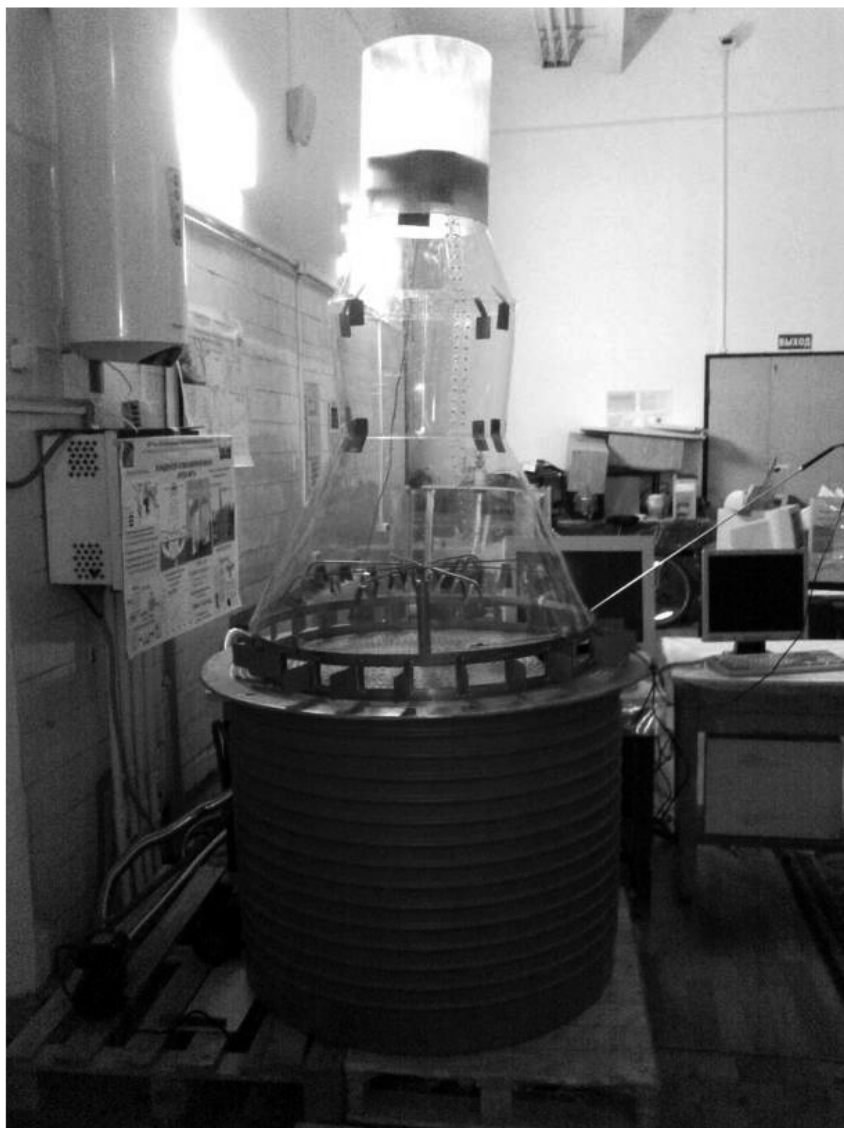
Рис.2. Общий вид физической модели градирни
