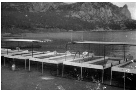
Рис. 2. Экспериментальный полигон Морского гидрофизического института РАН по масштабному культивированию спирулины для энергетических целей. Кацивели, Крым (1990-е гг.)
