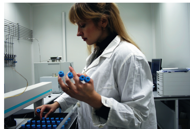
На переднем плане автосамплер газ-бенча — опции масс-спектрометра, позволяющей измерять состав стабильных изотопов кислорода, водорода и углерода ( \delta^{18}\text{O} , \delta\text{D} и \delta^{13}\text{C} ) в образцах воды, газа, карбонатов
